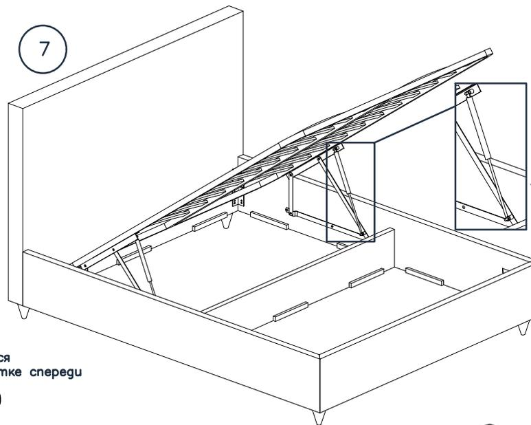
Газлифт 6 крепится к подъемному механизму 4 гайками м8 через шайбу м8 цилиндром вверх
